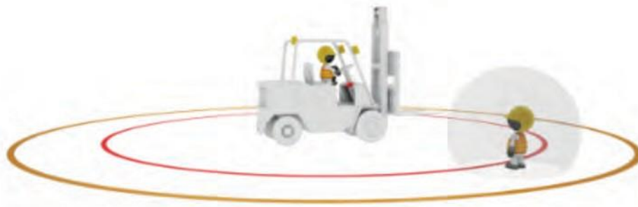
Figura 20: Operaio all'interno del raggio d'azione del macchinario
