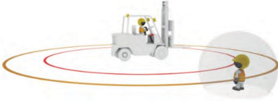
Figura 19: Operaio che si avvicina al raggio d'azione del macchinario in movimento
